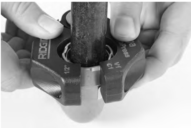
Slika 11 – Postavljanje prstenaste prese oko priključka
