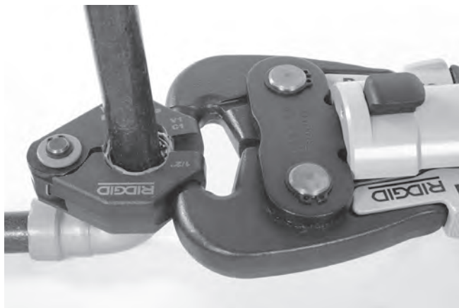
Figur 12 – Feste aktuatoren til pressringen
