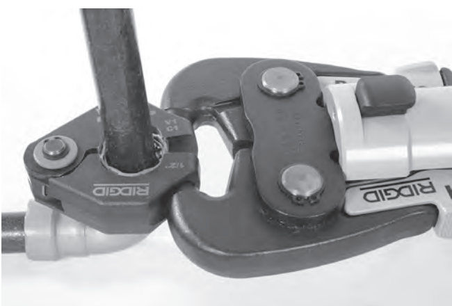
Figur 12 – Fästa aktuatoren på pressringen
