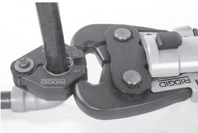
Figur 12 – Fastgørelse af aktuator på pressering
