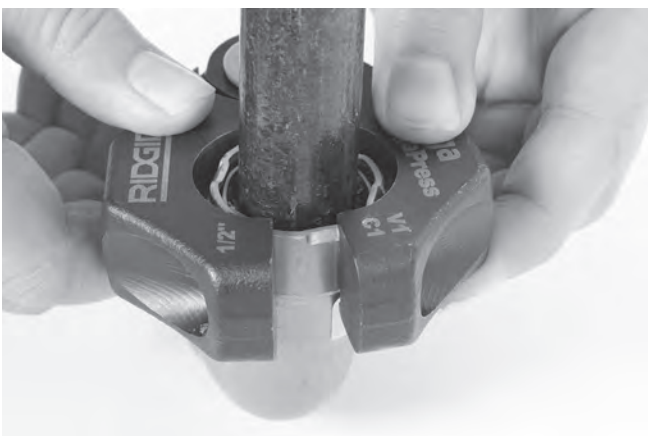
Abbildung 11 – Anbringen des Pressrings am Fitting
