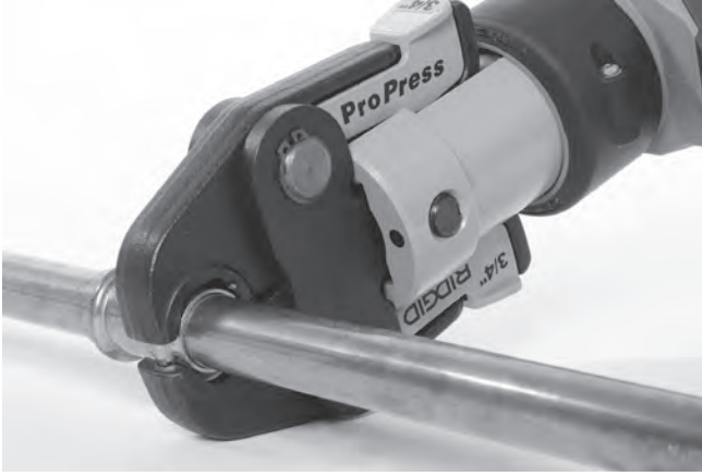
Şekil 9 – Makas Tipi Çeneleri Tespit Elemanın Etrafına Yerleştirme
