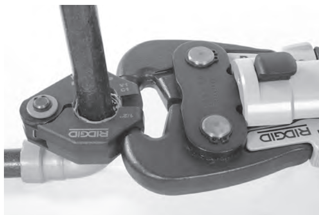
Abbildung 12 – Ansetzen des Stellantriebs am Pressring
