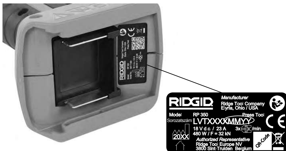
3. ábra – A gép sorozatszáma - A bekarikázott számjegyek jelölik a gyártás hónapját és évét. (YY = év, MM = hónap).
