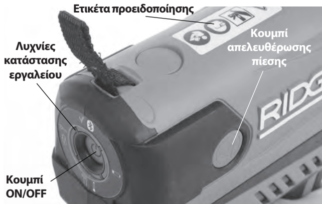
Εικόνα 6 - Λυχνίες κατάστασης/Ετικέτα προειδοποίησης
