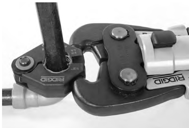
Slika 12 – Pritrjevanje sprožila na obroč za stiskanje
