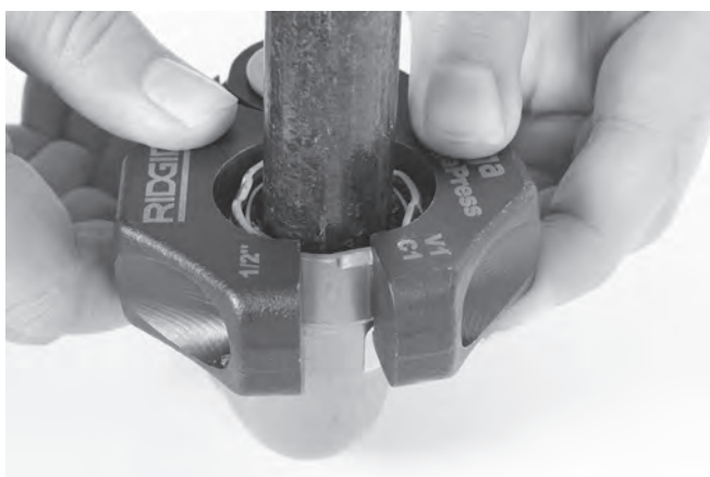
Rysunek 11 – Montaż pierścienia zaciskowego na okuciu
