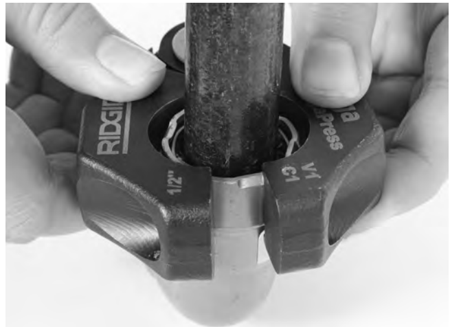
Figura 11 – Montaje del aro sellador en el acoplamiento
