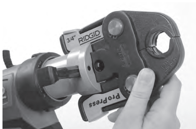
Figur 7 – Monteringsstap til tilbehør
