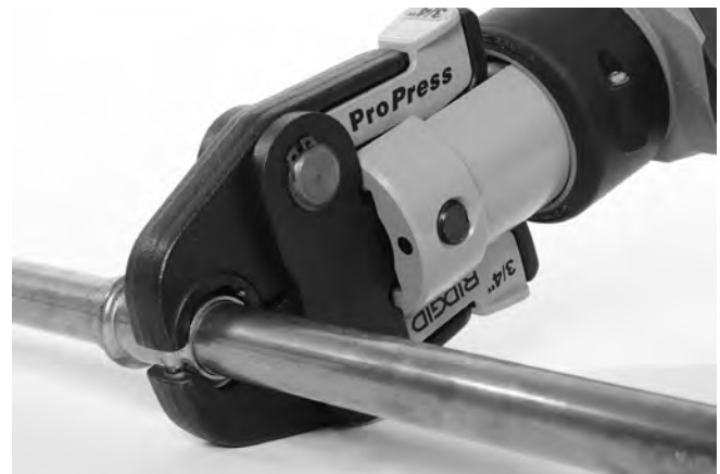
Slika 9 – Nameščanje škarjastih čeljusti okoli nastavka
