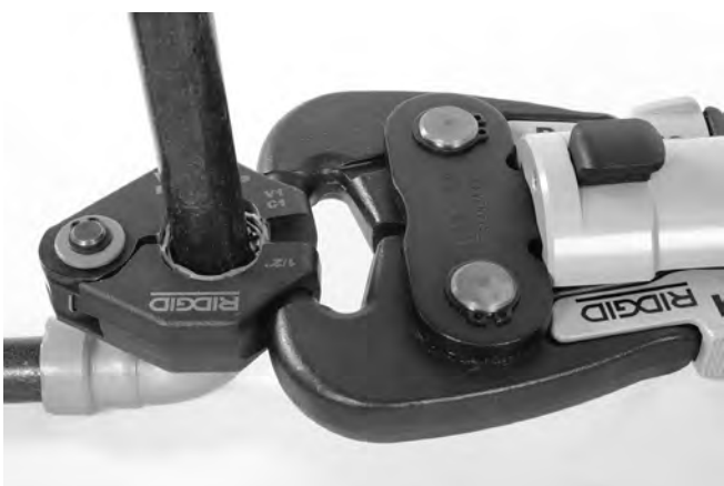
12. ábra - Működtető elem rögzítése a présgyűrűn
