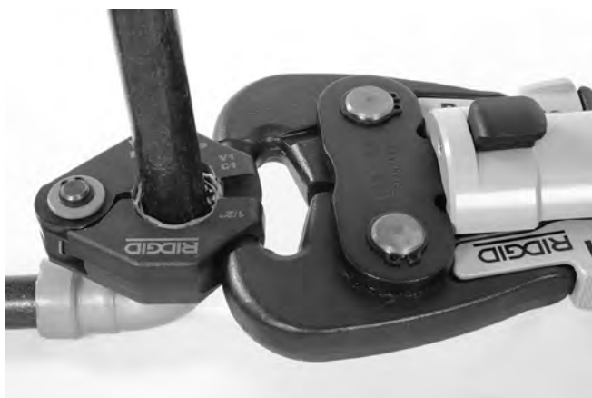
Slika 12 – Pričvršćivanje aktuatora na prsten za prešanje
