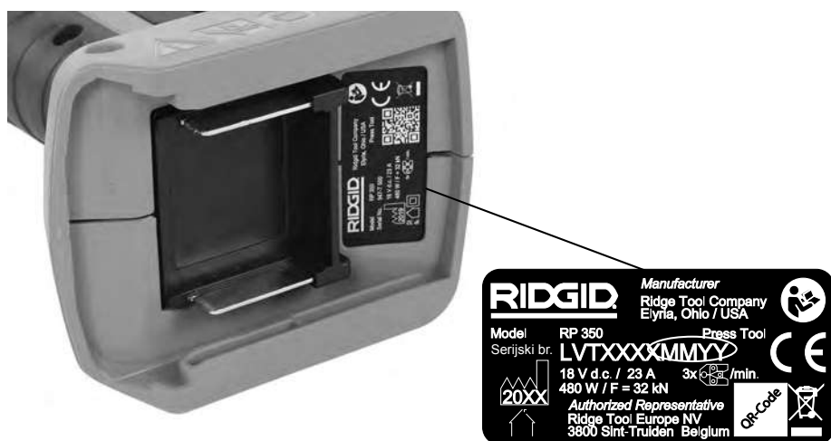
Slika 3 – Serijski broj aparata - zaokružene cifre ukazuju na godinu i mesec proizvodnje. (YY = godina, MM = mesec).
