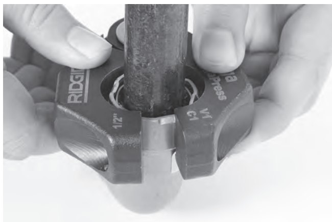
Figur 11 – Installere pressringen på utstyret
