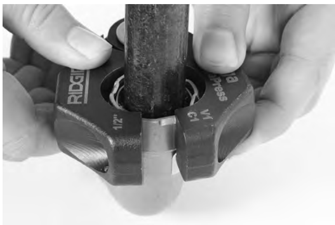
Slika 11 – Nameščanje obroča za stiskanje na nastavek
