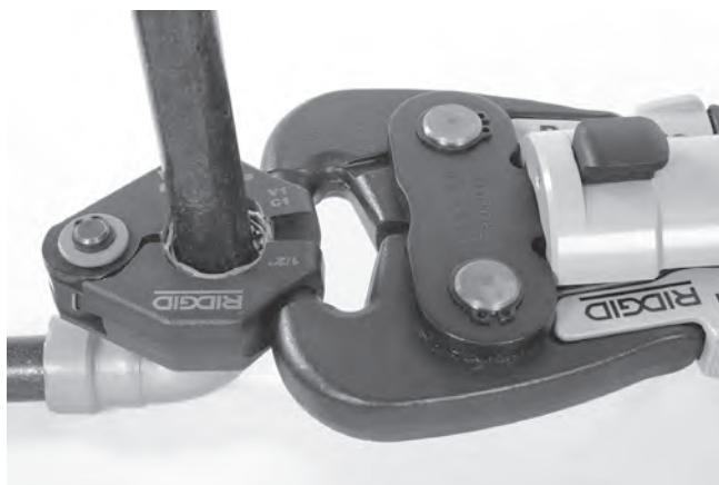
Figura 12 – Atașarea actuatorului la inelul de presare
