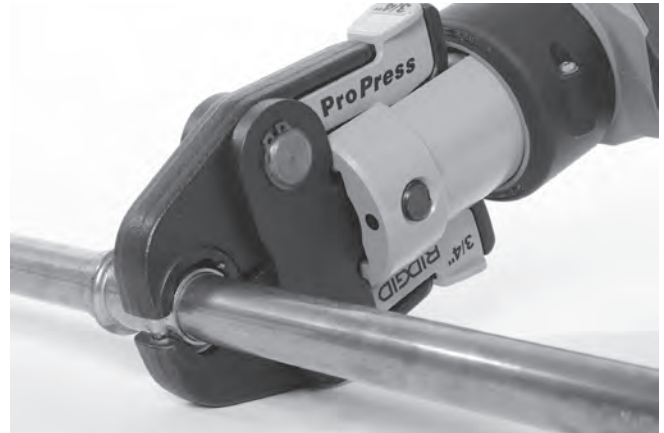
Rys. 9 – Umieszczanie szczęk nożowych wokół okucia
