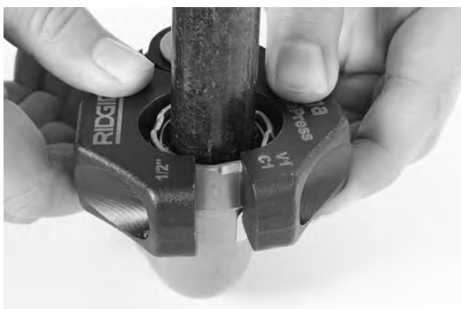
Obrázok 11 – Inštalácia lisovacieho krúžka na tvarovku
