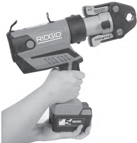
Figuur 8 – Het gereedschap vasthouden
