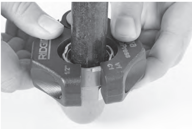
Figur 11 – Sätta dit pressringen på beslaget
