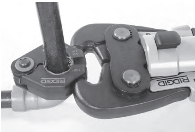
Figuur 12 – Aanbrengen van de actuator op de persring
