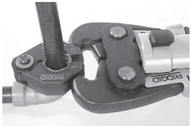
Figure 12 - Aggancio dell'attuatore all'anello di pressatura
