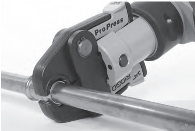
Figur 9 – Placera käftar av saxstil runt beslaget
