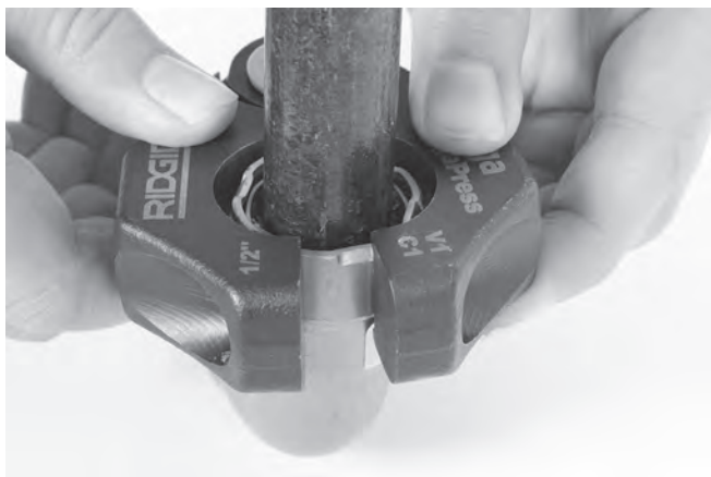
Figura 11 – Instalar o Anel de Prensagem no Engaste
