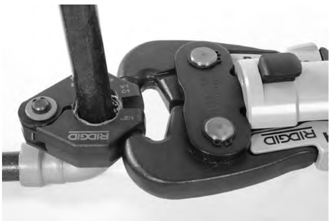
Slika 12 – Postavljanje aktuatora na prstenastu presu
