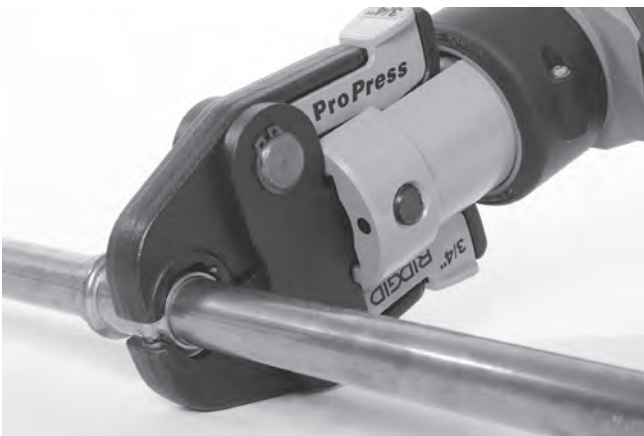
Obrázek 9 – Umístění nůžkových čelistí kolem armatury
