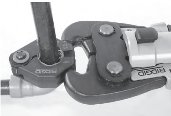
Kuva 12 – Käyttölaitteen kiinnittäminen puristusrenkaaseen
