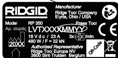
Εικόνα 3 – Αριθμός σειράς μηχανήματος - Τα κυκλωμένα ψηφία επισημαίνουν το έτος και τον μήνα κατασκευής. (YY = έτος, MM = μήνας).
