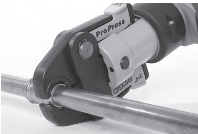
Figur 9 – Plassering av pressbakkene rundt presskoblingen
