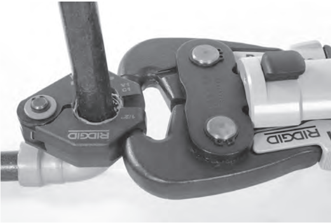
Şekil 12 – Aktuatörün Pres Halkasına Takılması
