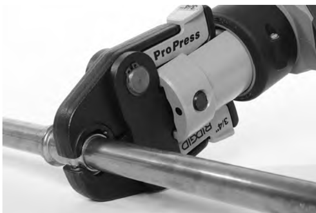
Slika 9 – Postavljanje čeljusti u obliku škara oko umetka
