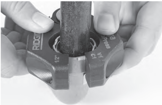
Kuva 11 – Puristusrenkaan asentaminen liittimeen
