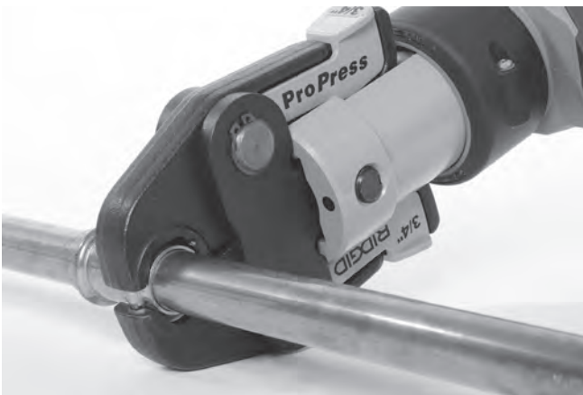
Figur 9 – Placering af saksekæber omkring fitting
